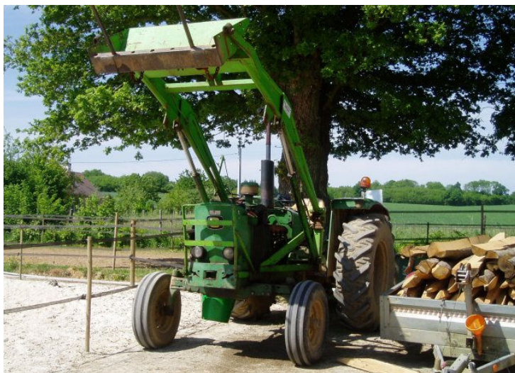
Kuva 4. Kuvan traktoria nuori työntekijä ei saa kuljettaa, sillä siinä ei ole vaadittua turvaohjaamaa. (Heikkinen 2008).
